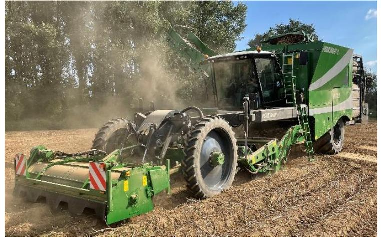
**Le bâti arracheur** est parfaitement visible depuis le poste de conduite grâce au châssis large. Le tapis ramasseur est équipé d'un secoueur rotatif. La gestion de la profondeur est réalisée par des palpeurs. Les roues diabolos favorisent la montée de la butte vers le tapis ramasseur. La pression d'appui est réglable hydrauliquement depuis la cabine et ces roues sont escamotables pour les conditions humides. Les disques sont entraînés hydrauliquement.
