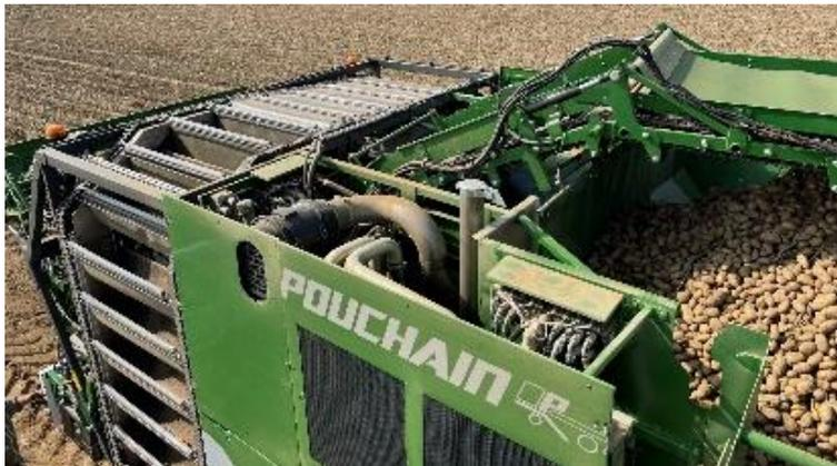
Le **moteur Volvo** placé transversalement est idéalement situé au-dessus du pont arrière. Sa position contribue à la stabilité de la machine et permet de réduire significativement les nuisances sonores en cabine. Il développe 510 ch, fonctionne à un régime de travail de 1100 à 1300 tr/min et respecte la norme anti-pollution stage V. L'aspiration d'air haute, limite l'encrassement des filtres et des radiateurs.
