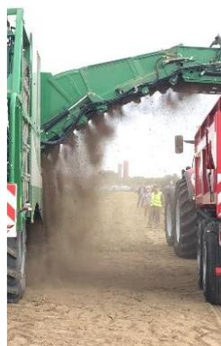
**La trémie de 16 m<sup>3</sup>** permet d'emporter 10T de produit. Le tapis de fond est indépendant du tapis de vidange, ce qui autorise une vidange même partielle de la trémie et ce, sans arrêt de la machine, augmentant ainsi le débit de chantier. La hauteur du tapis de remplissage est gérée automatiquement. Le fond de la trémie est équipé d'un système de lubrification. Le tapis de vidange à barreaux vulcanisés et ameneurs en caoutchouc permet d'évacuer la terre fine sans abîmer le produit.
