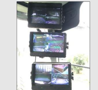
3 écrans reliés à 12 caméras infra-rouges pour le contrôle des différentes parties de la machine
