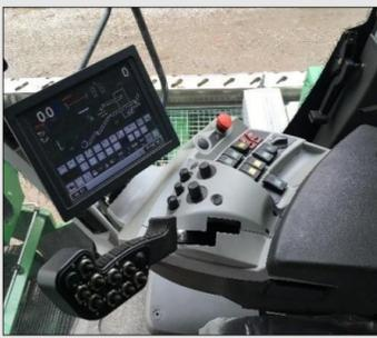
L'ensemble des commandes de l'arracheuse sont regroupées de manière ergonomique sur l'accoudoir droit: réglage des différents organes de la machine, écran de contrôle, ordinateur de bord et levier d'avancement. 3 modes pré-réglés permettent de s'adapter rapidement aux différentes conditions de récoltes
