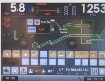
Ordinateur de bord pour la gestion de chaque élément de la machine (réglage de la vitesse de tous les organes et inversion du sens de rotation de ceux-ci) et pour l'affichage des informations (vitesse d'avancement, surface travaillée, données moteur...)
